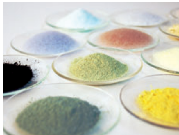
図 1. 噴霧火炎合成法を用いると、無機ナノ粒子の合成材料の種類はほぼ無限に広がります。類似した粒径分布を持つ、酸化物、無機塩および金属のさまざまなナノ粒子の写真です。（Nanograde LLC 提供）。
