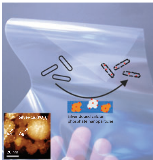
図3. リン酸カルシウムのナノ粒子の表面に1~2 nm銀ナノ粒子が均一に分布した複合ナノ粒子。これらのナノ複合体は、サイズが小さく、無機塩ナノ粒子の表面に分散しているため、通常の銀を用いた場合に比べてバクテリア滅菌効率が1000倍も高くなります。
