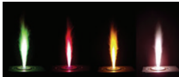
図 2. 供給される金属によって、無機ナノ粒子製造中の火炎は異なる色を呈します。この例では、銅、ストロンチウム、セリウムおよびビスマス（左から右へ）を含む有機金属前駆体の燃焼を示しています。
