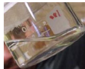
図 3 加熱によって流動性を持ったゲルの入ったビーカーを傾けた様子
