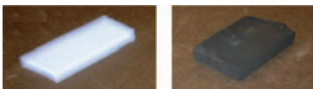
図1. 未ドーブ（左）および炭素ドーブ（右）の超低密度 \text{SiO}_2 網目構造材料の外観
