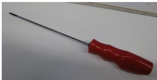
6. 上記のネジを、1.5mm 六角ドライバーを用いて増し締めしてください。
