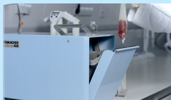
Disolver suavemente y colocar en el stomacher para homogeneizar la muestra en el caldo de enriquecimiento
