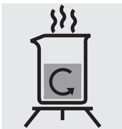
200 ml Probelösung in einem Becherglas auf der Heizplatte fast bis zur Trockne eindampfen.
