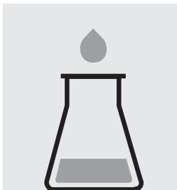
1,0 ml Probe und 9,0 ml dest. Wasser (empfohlen wird Art. 115333, Wasser für die Chromatographie LiChrosolv®) in ein Glasgefäß pipettieren.
