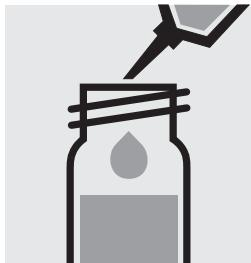
1,0 ml **Mg-1K** mit Pipette zugeben, mit Schraubkappe verschließen und mischen.
