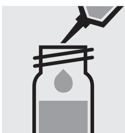
1,0 ml **Ag-6** mit Pipette zugeben, mit Schraubkappe verschließen und mischen.
