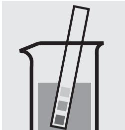
pH-Wert der Probe überprüfen, Soll-Bereich: pH 4 – 10. Falls erforderlich, tropfenweise mit verdünnter Natronlauge bzw. Schwefelsäure pH-Wert korrigieren.
