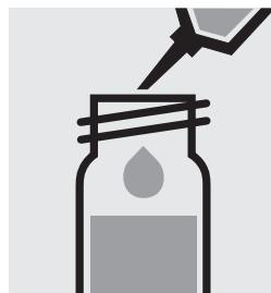
5,0 ml **Isobutymethylketon z. A.** (Art. 106146) mit Pipette zugeben, mit Schraubkappe verschließen.
