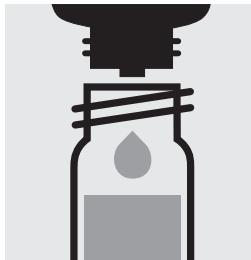
5 Tropfen **P-1K** zugeben, mit Schraubkappe verschließen und mischen.
