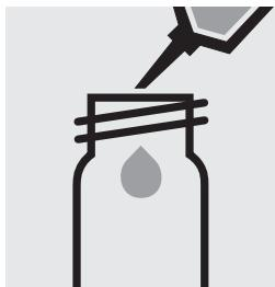
4,0 ml NO<sub>3</sub>-1 in eine trockene, leere Rundküvette (Leerküvette, Art. 114724) pipettieren.
