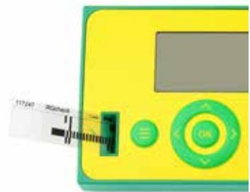
Insérez la bandelette-test pour le RQcheck dans l'adaptateur de bandelette-test et appuyez sur la touche [DEMARRAGE] (lancer la mesure).
