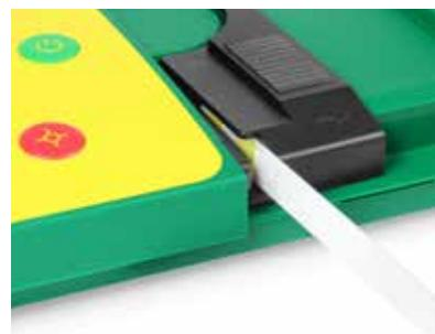
La mesure commence automatiquement après la fin du temps de réaction.
