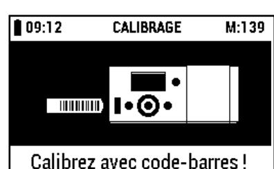
Retirez la languette code-barres de calibrage du paquet (incluse dans le contenu de livraison du RQflex® 20).
