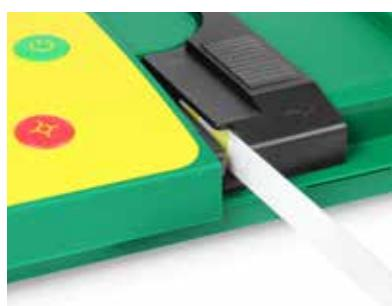
Измерение начинается автоматически по истечении времени срабатывания. Результат измерения отображается на экране и автоматически сохраняется.
