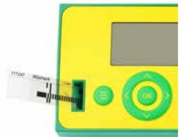
Вставьте тест-полоску для RQcheck в адаптер для тест-полосок и нажмите на кнопку [СТАРТ - Начать измерение].
