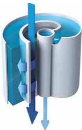
Vista del flujo a través de una membrana de RO Advanced introducida en un cartucho. El flujo tangencial limita el riesgo de ensuciamiento.
